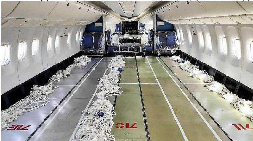
Рисунок 5 - Boeing 767, переоборудованный под перевозку грузов
