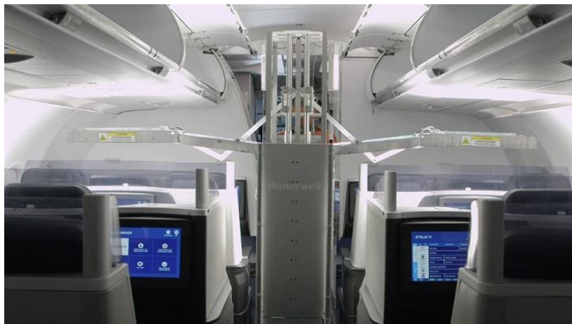
Рисунок 2 - Робот Honeywell для дезинфекции салона самолета
